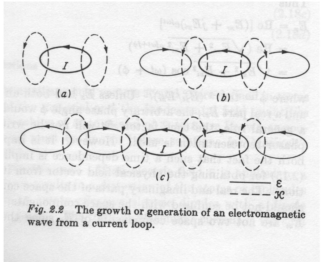
*Propagazione del campo elettromagnetico*
